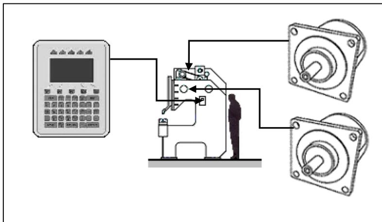
2. Linea taglio **Gabella**: sostituzione del pulpito originale con un pulpito a norma, dotato di controllo automatico con tastiera e display, pulsanti, selettori e connessione ad aspo. Al controllo viene connesso un encoder per ruota metrica
