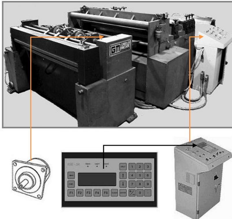
3. Linea bulinatura **Camu**: sostituzione del pannello di controllo originale con pannello con caratteristiche avanzate, quali memoria per 100 programmi pezzo, 80 tipologie di bulinatura, 50 passi di bulinatura per programma
